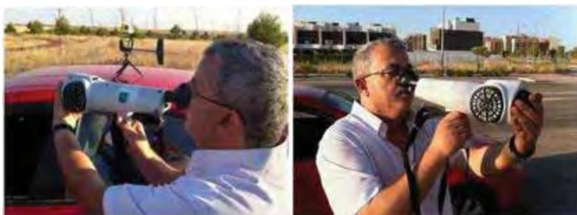
**Figura 4. Detalle de los controles olfatométricos realizados en el PAU de Vallecas**
