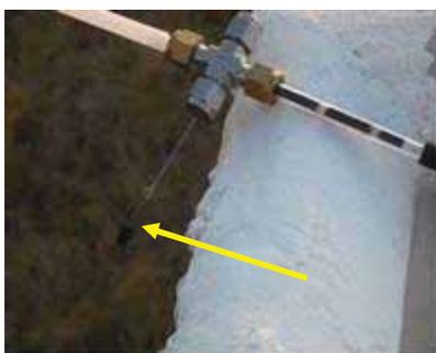
**Figura 5. Toma de muestras de aire en inmisión con bomba captadora y fibras SPME**
